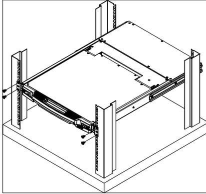
2. 当第一个人仍旧托住 CL1000 机体时，第二个人将 L 支架从后端滑入 CL1000 侧边的机架托架中，直到支架片突出接触到机架，然后将 L 型支撑片固定在机架上。
