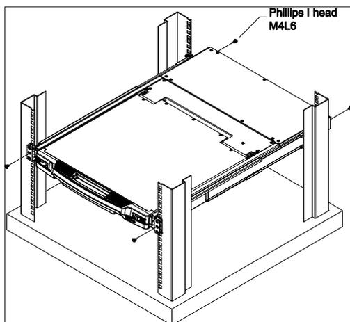
5. 抽拉CL1000，将其打开和盖起数次，以确保设备妥善安装，操作顺畅。(关于打开和关闭操作，请见第11页的*打开控制端*。)
