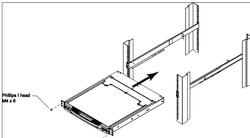
4. 将滑轨托架推入滑轨支架上, 直至其接触到CL1000的后部, 然后用本包装提供的螺丝将滑轨支架固定到CL1000的后方(完全拧紧螺丝)。
