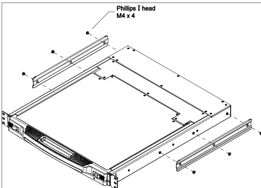
2. 将左右简易安装滑轨连接到机架内侧。支撑CL1000的支架铁片应在内侧。
